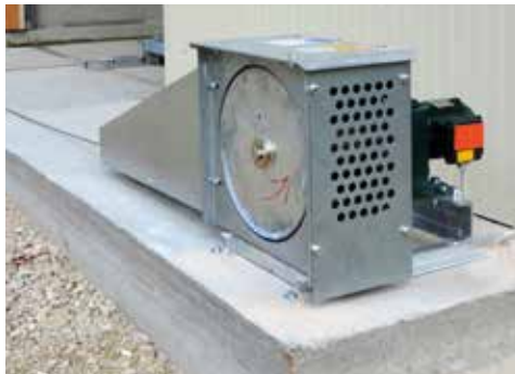
Robuste Antriebswinde am Boden montiert.
