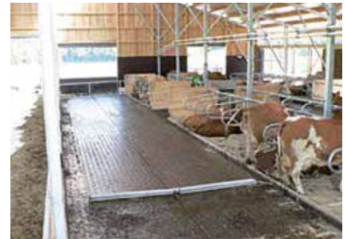
Alternativ: Verkürzter Breitschieber mit starrer Seitenklappe, Fressplatz seitig für ungestörtes Fressen.
