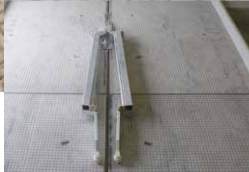
Breitschieber schnell zusammengeklappt für die Durchfahrbarkeit.
